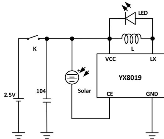
图 6. 太阳能电池控制使能
