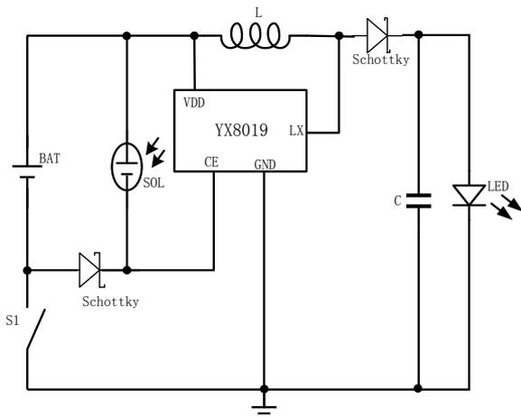
图 7. 关断电源后可充电的电路
