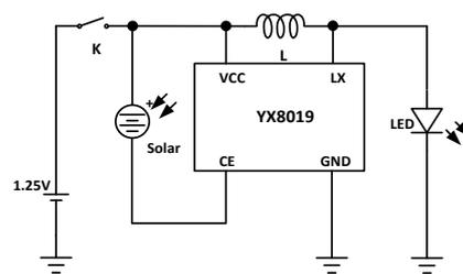
图 2. 太阳能电池控制使能
